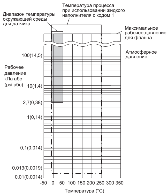
Рис. 1-3. Рабочее давление и температура процесса (Жидкий наполнитель: силиконовое масло для применения в условиях высокой температуры и высокого вакуума)
